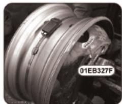
Установите шину на диск, накачайте до стандартного давления, отбалансируйте и установите на транспортное средство.
