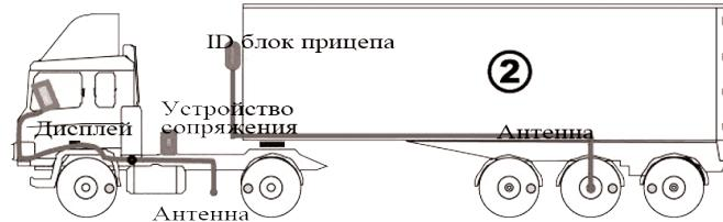
Включите ID блок прицепа, нажмите и удерживайте кнопку «ключ» в течение 4 секунд. Индикатор загорится зеленым, ID блок прицепа приведен в состояние регистрации.
