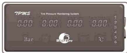
Одновременно с этим дисплей освежит данные о состоянии шин. Полученные значения давления в шинах будут автоматически записаны как контрольные параметры основного давления.
