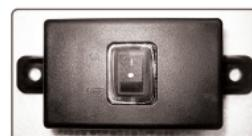
ID блок прицепа получит идентификационный номер тягача и запомнит его. Индикатор отключится.
