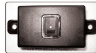
ID блок прицепа получит идентификационный номер грузовика и запомнит его. Индикатор отключится.
