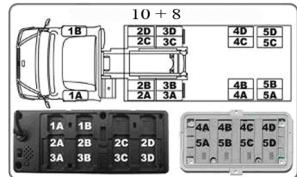
Установите ID модули в соответствии с конфигурацией Вашего ТС.
