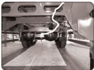
Закрепите antennu кабельным хомутом.
