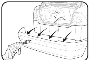
4. просверлите посадочные отверстия, демонтируйте бампер. Толщина бампера не должна превышать 4,5 мм
