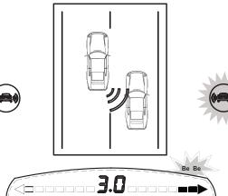
Предупредительный светодиод загорается при обнаружении помехи в слепой зоне, а звуковой сигнал прозвучит при включении поворотников в сторону помехи
