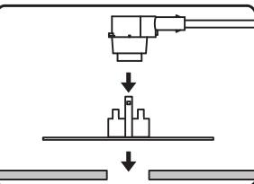
5. приклейте крепление датчика с внутренней стороны бампера, предварительно обезжирив поверхность. Вставьте датчик в крепление
