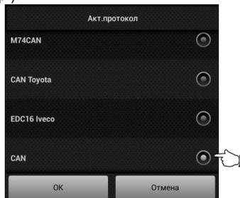
5. Необходимо проверить правильность выбора протокола: завести двигатель, выйти в главный экран, нажать кнопку "Параметры" и проверить корректность следующих параметров: обороты, температура охлаждающей жидкости двигателя.
