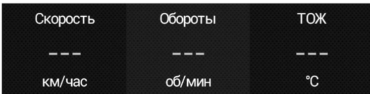
4. Если после завершения автоматического определения протокола не показываются параметры "Скорость", "Обороты", "Температура охлаждающей жидкости", значит протокол определить не удалось, требуется установить его вручную: заглушите двигатель автомобиля, выключите зажигание и произведите настройки МК:
