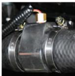
3. Заверните датчик температуры охлаждающей жидкости в установленный тройник.
