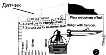
Рис. 5. Шаблон для правильной установки угла наклона датчика.
