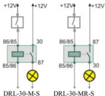
Контроллер DRL-30-M-S позволяет правильно использовать фары ДС, БС или ПТФ в режиме ДХО - дневных ходовых огней. Контроллер DRL-30-M-S автоматически включает фары (с подсадкой яркости – можно изменять) при включении зажигания и пуске двигателя. Для подключения внешних цепей (для активации и блокировки режима ДХО) к реле DRL-30-M-S можно напрямую проводами от доп. разъема.
