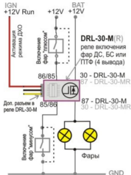
Рис. 3. «Простое подключение» DRL-30-M(MR)-S для управления фарами БС или ПТФ с обеспечением «Режима ДХО» - активация «режима ДХО» подачей «+12В» на красный провод доп. разъема реле, штатное включение фар – «минусом» или «плюсом».
