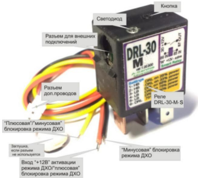
Рис 4. Внешний вид реле-контроллера DRL-30-M-S
