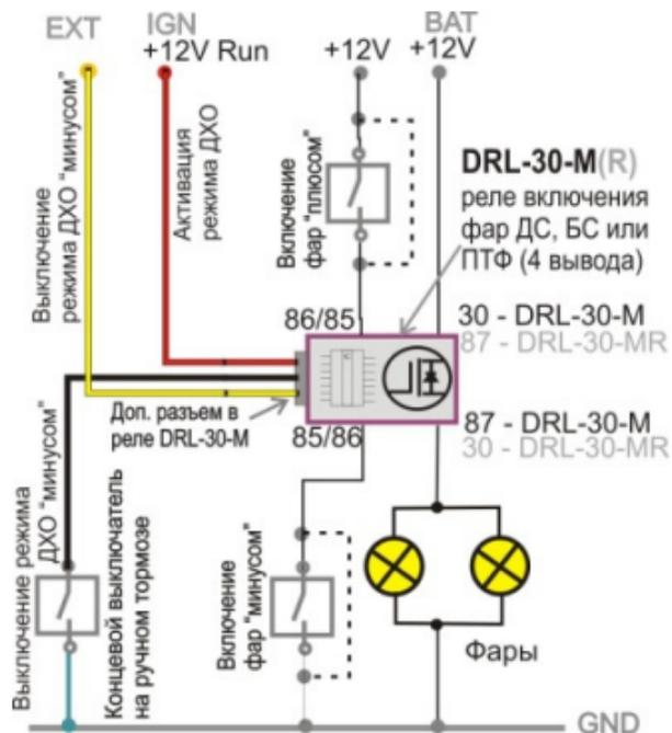
Рис. 2. «Полное подключение» DRL-30-M(MR)-S для управления фарами ДС, БС или ПТФ с обеспечением «Режима ДХО».
