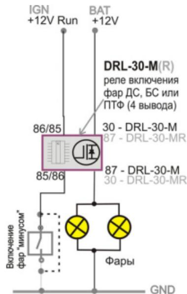
Рис. 7. Подключение реле в «Режиме 7»
