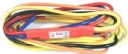
Адаптер D-04 – внешний вид с проводами для подключения
